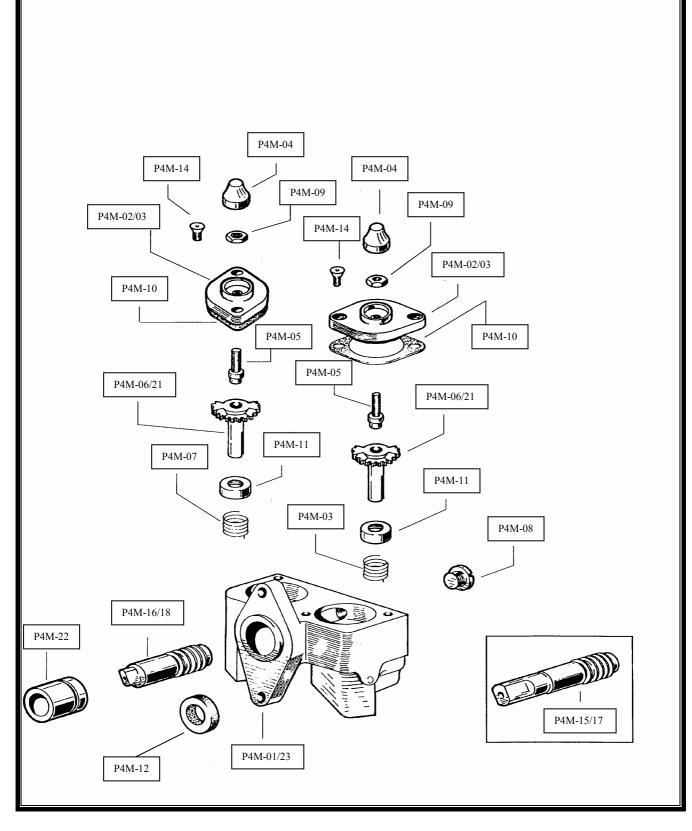
**SPARE PARTS LUBRICATING PUMP AT 4 DELIVERIES**
